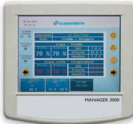
целом. Возможно выведение подробной информации по каждому из пунктов. Регулирование может осуществляться по пропорциональному или пропорционально-интегральному закону, а также по специальному алгоритму с зоной нечувствительности и динамическим изменением уставки. Возможен сдвиг уставки (в том числе в зависимости от температуры наружного воздуха) и ограничение нагрузки по соответствующему сигналу на аналоговые входы.
